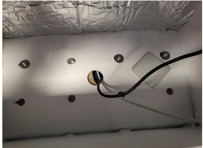
1 Ansicht der 8 Befestigungsbohrungen und der Kabelzuführung im Gerät von innen
